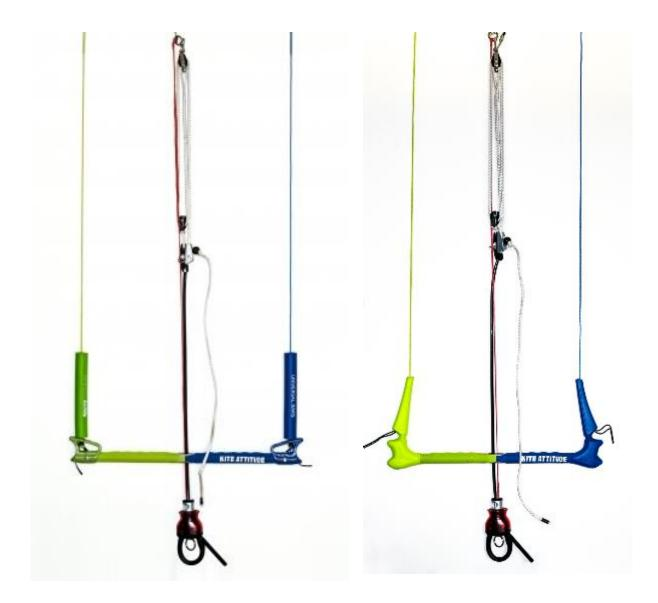
La gaine PU (fabrication française spéciale pour Kite Attitude) est montée en force sur le dyneema, de façon à éviter que le sable n'entre à l'intérieur. A ce jour, aucune casse n'a été constatée. La ligne de sécu passe à *l'extérieur* du tube PU du border choquer, et pas à l'intérieur. Ceci permet d'avoir une corde doublée et donc plus résistante, et sans risque d'avoir du sable à l'intérieur.
