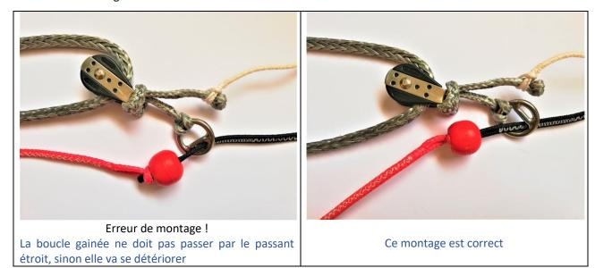
Montage avec une barre avec Y (préligne avant grise de 1,15 m) :
